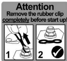
**Antes da colocação em funcionamento, extrair completamente a aba de borracha!**
